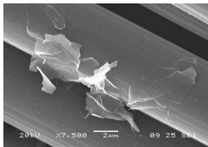
Figura 6 Detalle grafeno sobre fibra de carbono.
