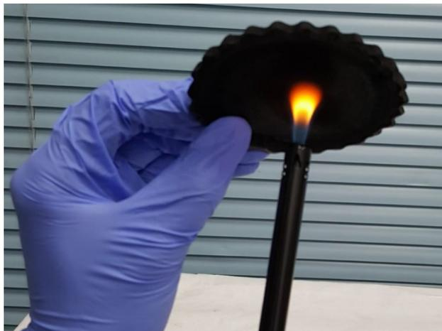
*Figura 26* Probeta de LDPE-grafeno.
