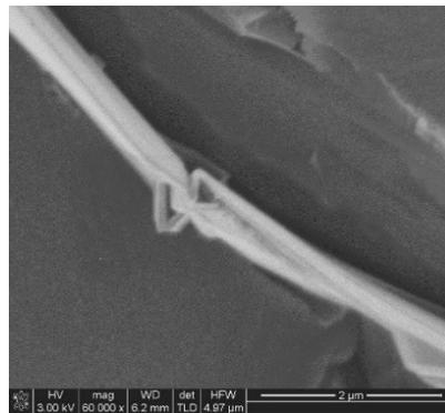
Figura 24 Superficie fractura criogénica de la resina dopada con un 2% en peso de GNPs.
