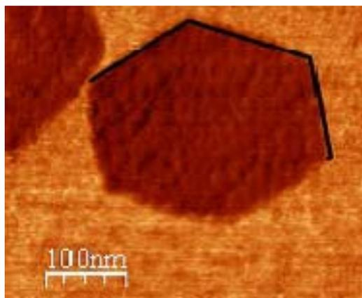
**Figura 18** Esta imagen de microscopía de fuerzas atómicas (AFM) muestra los cristales de grafeno crecidos sobre una superficie de vidrio, en un momento del proceso de crecimiento previo a que el film cubra completamente la superficie.
