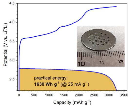
Figura 12 Perfil de carga-descarga y fotografía (inset) de la batería Li-O<sub>2</sub> con grafeno.
