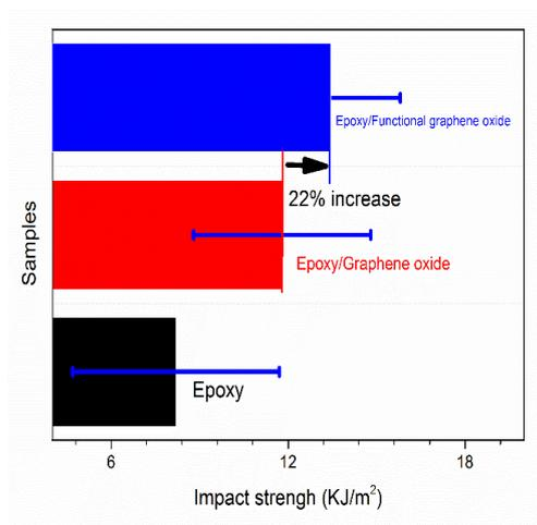
**Figura 7** Comparación de la resistencia al impacto de la resina epoxi (barra negra), la resina epoxi con óxido de grafeno (barra roja) y la resina epoxi con óxido de grafeno funcionalizado (barra azul).
