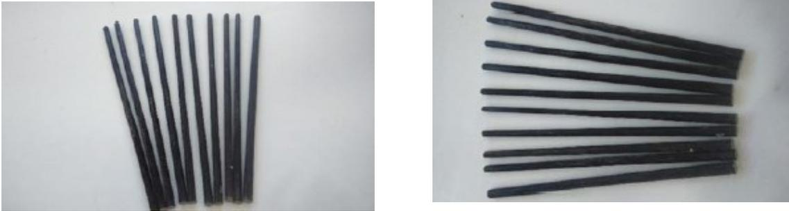
*Figura 13* Perfiles avanzados con grafeno obtenidos mediante pultrusión.
