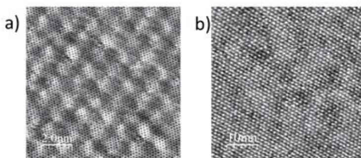
*Figura 15* Imágenes de la superficie del sistema formado por un grafeno y un sustrato no metálico después del degasificado obtenidas con un microscopio de efecto túnel (STM) a dos tamaños diferentes (ver escala de 2 nm (a) y 10 nm (b)).
