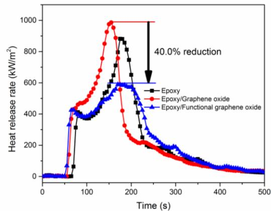
**Figura 8** Comparación del calor liberado al quemar por la resina epoxi (línea negra), la resina epoxi con óxido de grafeno (línea roja) y la resina epoxi con óxido de grafeno funcionalizado (línea azul).
