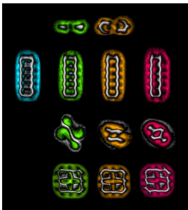
Figura: imágenes coloreadas de microscopía de fuerza atómica de las cuatro moléculas estudiadas (primera fila: azobenceno; segunda fila: pentaceno; tercera fila: TCNQ; cuarta fila: porfina) en los diferentes estados de carga generados (primera columna en azul: positiva; segunda columna en verde: neutra; tercera columna en naranja: negativa; cuarta columna en rojo: doblemente negativa). / IBM Research.
